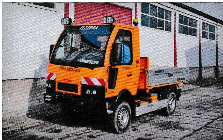
Plně elektrifikované vozidlo druhé generace ELZebra je dodáváno s různými typy elektromotorů
